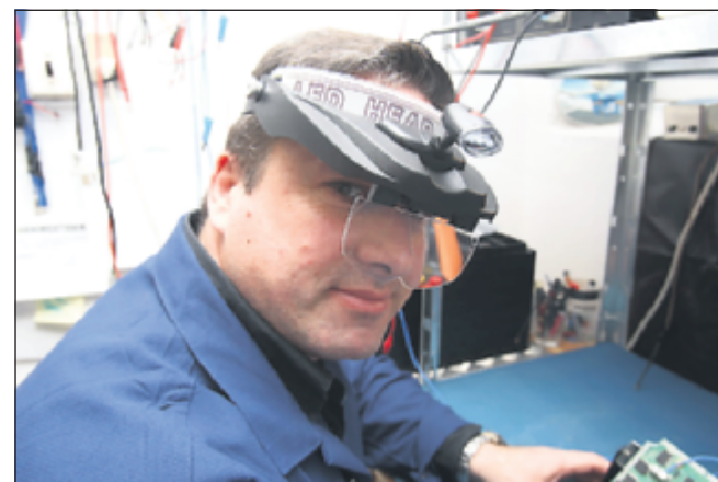
Fejlfinding og reparation af styrebokse kræver en del udstyr, og Prokopis Kloster anvender briller med indbygget forstørrelse og en kraftig LED-pandelampe for at kunne se de små enkeltdele.
