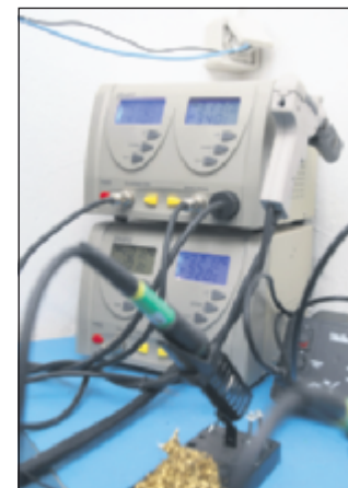
Lodningen foregår ved hjælp af en varmluftlodder, og her kan lodtemperaturen styres hårfint, for loddes der med en for stor temperatur, kan printet eller komponenten tage skade.
